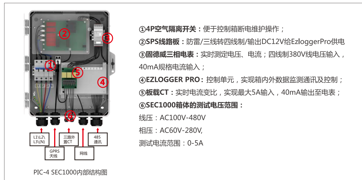
PIC-3 固德威SEC1000智慧能源控制器
