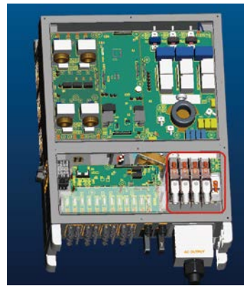
PIC-3 逆变器交流端子接线
