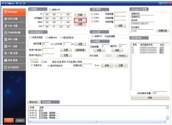
图 5.2-6 静态IP模式 ProMate 软件与EzLogger Pro连接
