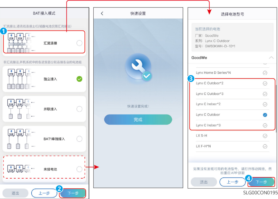
通过 LCD 屏幕设置电池接入模式 设置锂电池参数
