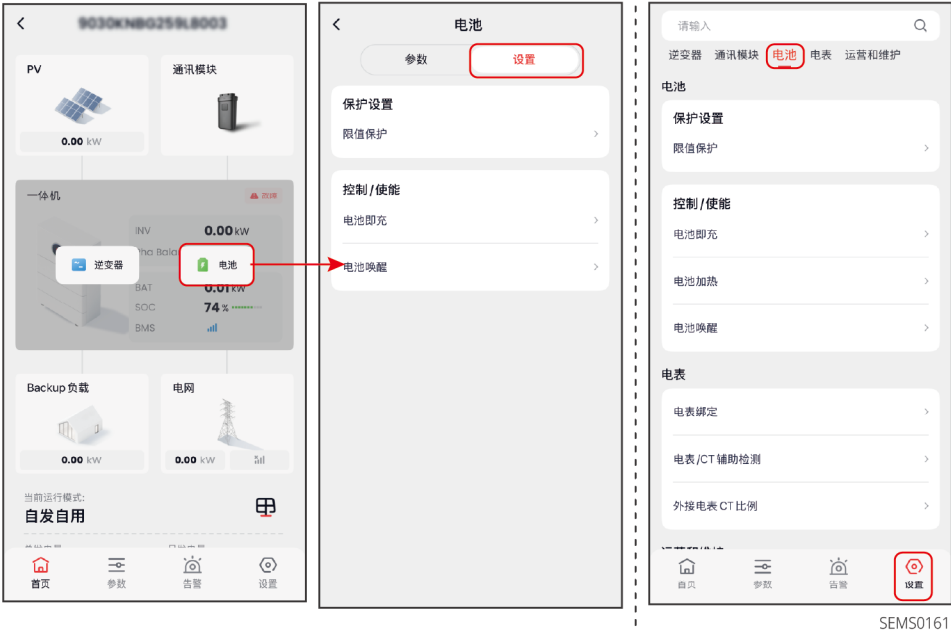
图31 设置电池参数
