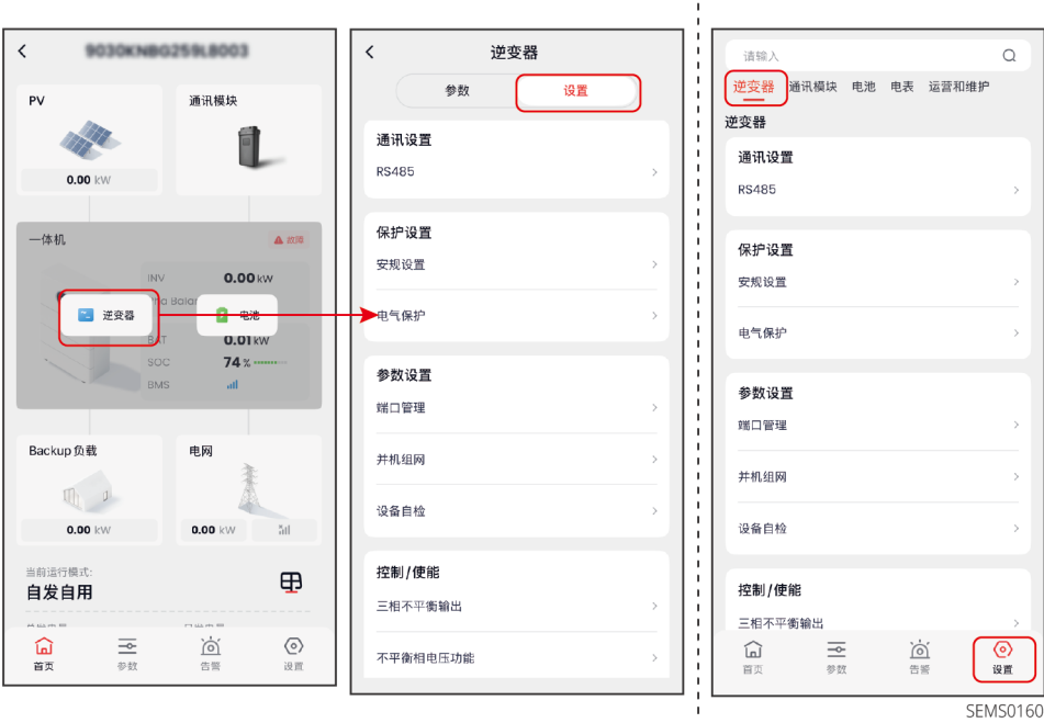
图26 设置逆变器参数
