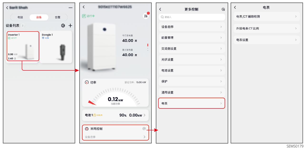
图21 设置电表参数
