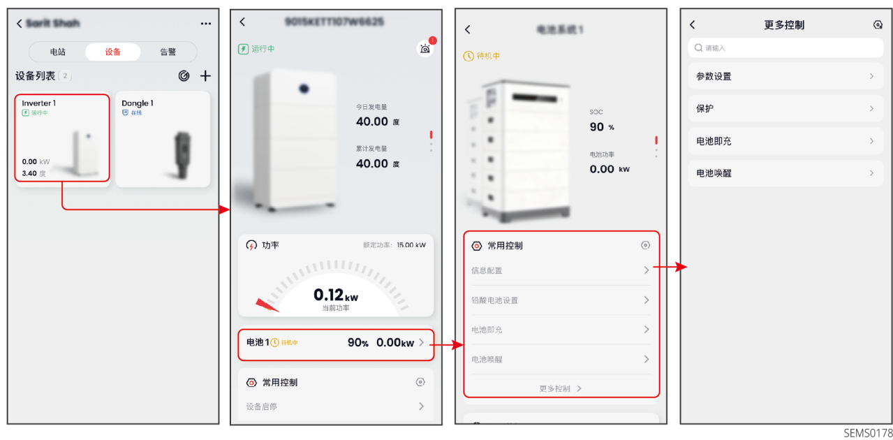
图20 设置电池参数
