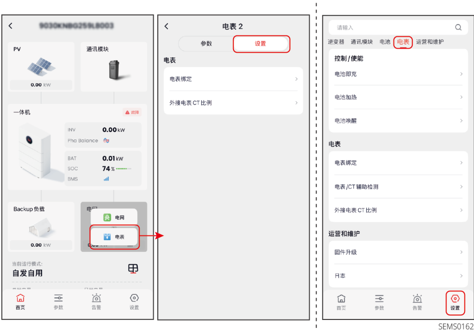
图33 设置电表参数
