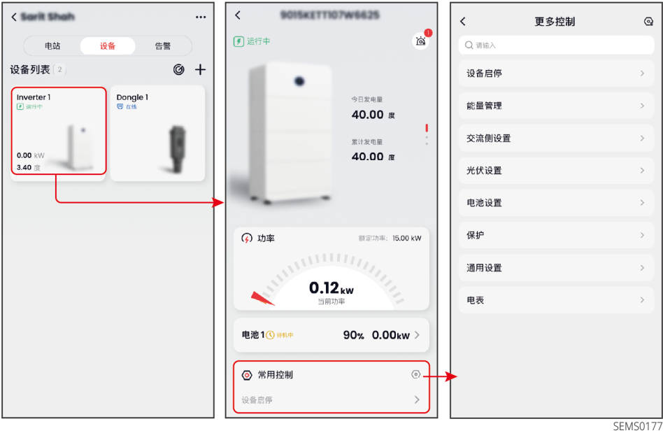
图17 设置逆变器参数
