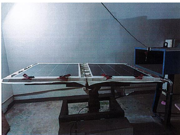
轻质产品抗风性能风洞试验
