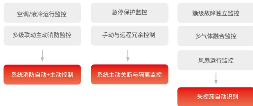
1. 通过温度信息、烟雾传感器,气体CO/CO2/VOC传感器、其他故障数据,确定有倾向于热失控或者正在进行热失控的具体的包级、簇级、舱级;
